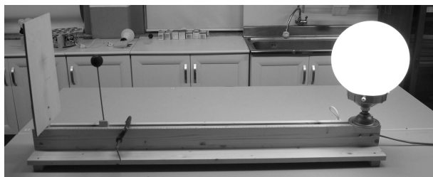
그림 11. 직경이 큰 단일 광원을 이용해 구성된 일식 실험 장치.
